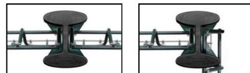
Poteau à encoche permettant de réaliser un angle 90°
